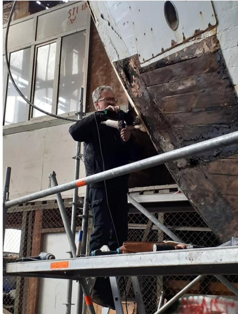
Die Muttern an den Spanten werden abgeflext,
