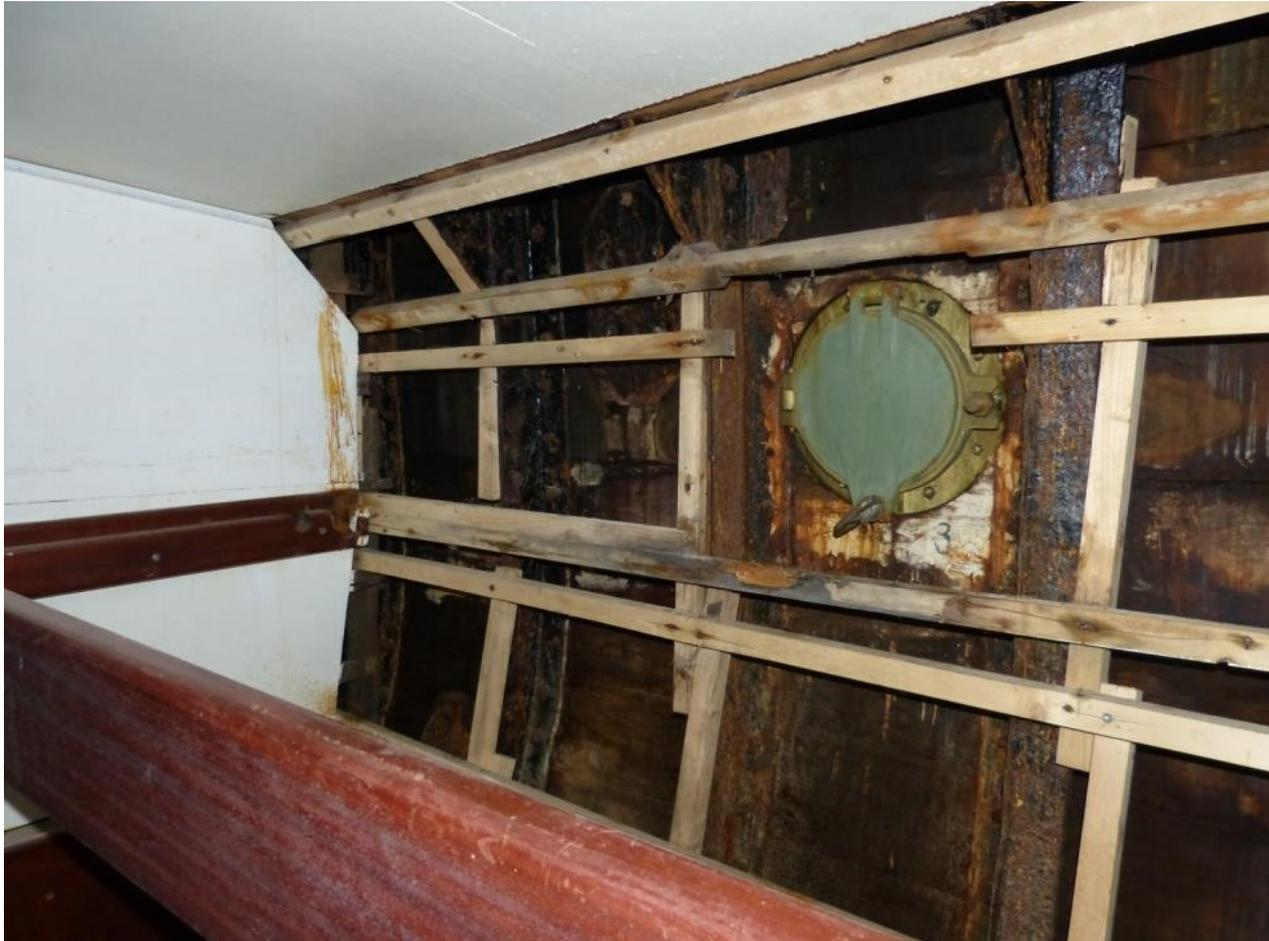
Die freigelegte Spanten und Außenbeplankung,
